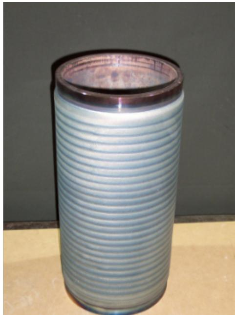
为什么碳化钨涂层要用火焰？航空发动机压缩机的前后外壳分别由铁基和镍基合金制成，在使用过程中，前后壳的对接接头处于振动状态，容易产生冲击磨损。原来的碳化钨喷涂耐磨涂层是由于硬度。韧性越低，磨损一段时间后损坏的伤害就越大，前后外壳的寿命就会缩短。因此，制备高耐磨性涂料是解决航空设备磨损问题，延长航空设备使用寿命的迫切问题。在工业中，硬质合金是一种理想的耐高温、耐磨损涂层材料，在设备上喷涂耐磨防护涂层可大大提高其性能和使用寿命。制备涂层有多种技术选择。包括堆焊、热喷涂、激光熔覆等，用于铁镍基合金，常用的是热喷涂。耐磨涂层包括底涂层与面涂层。广东碳化钨涂层厂家
